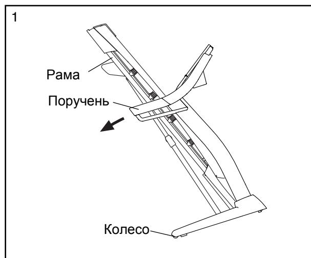
2. Потяните беговую дорожку в противоположную от поручней сторону и катите её на колесах, таким образом перемещая её в нужное место. **ВНИМАНИЕ:** не двигайте беговую дорожку, не наклоняя ее назад, не тяните за каркас, и не передвигайте беговую дорожку по неровной поверхности.
