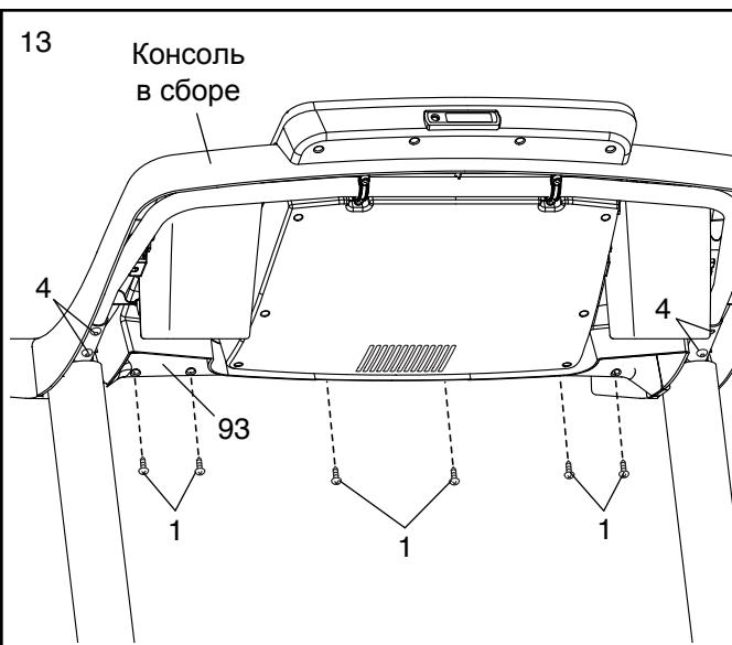
14. Проверьте зазоры между собранными поручнями (B, D) и консолью (F).
