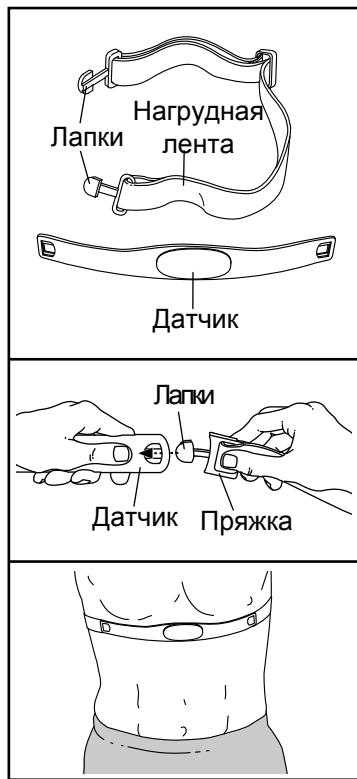
гается справа вверху. Затем прикрепите к датчику другой конец нагрудной ленты. Если нужно, длину ленты можно отрегулировать.
