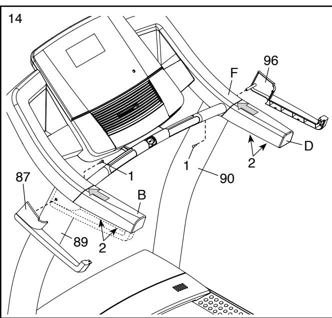
15. Закрутите винт 8 x 3/4" (2) в левую внешнюю накладку стойки (87) и в нижнюю часть левого поручня в сборе (B). Убедитесь, что винт не перетянут.
