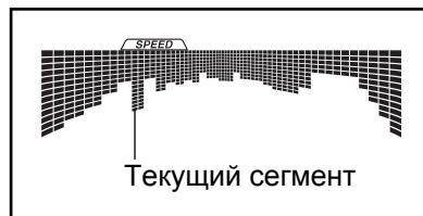
Мигающий сегмент профиля показывает текущий сегмент тренировки. Высота мигающего сегмента показывает скорость и наклон для текущего момента тренировки. В конце каждого сегмента звучит сигнал, предупреждающий о переходе на следующий сегмент, который начнет мигать. Если для следующего сегмента запрограммированы другие скорость и наклон, то новые данные будут мигать на дисплее, а беговая дорожка будет автоматически приспособливаться к новой скорости и/или наклону.
