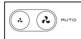
тор. Нажмите кнопку с большим значком вентилятора, чтобы выбрать автоматический режим обдува или выключить механизм.
