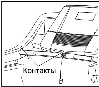
захвачен, символ сердца на дисплее калорий начнет мигать при каждом биении сердца, появится один или два штриха, а затем ваш пульс будет показан. Для наиболее точного определения частоты пульса, держитесь за контакты около 15 секунд.
