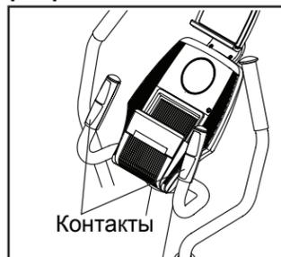
Когда ваш пульс будет измерен, значение появится на экране. **Для наиболее точного определения частоты пульса, держитесь за контакты около 15 секунд.**
