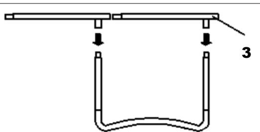
Для данного процесса нужно два человека. Один человек поднимает собранные нижние ножки, шаг 1, вертикально и вставляет один из наконечников стойки для защитной сетки (3) в вертикальный удлинитель ножек. Другой человек держит другой конец и вставляет эту часть в другие нижние ножки как на рисунки. Теперь Вы собрали две нижние ножки, которые крепятся к 2-м стойкам для защитной сетки.
