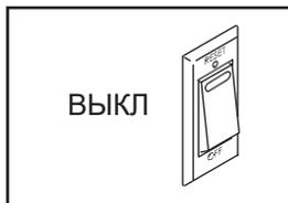
**ВАЖНО:** Консоль оснащена функцией демо-режима, предназначенного для демонстрации беговой дорожки в магазине. Если перевести консоль в демо-режим, то после подключения беговой дорожки к сети и установки выключателя в положение «ВЫКЛ» (при этом ключ не должен быть установлен в консоль), на экране отобразится демонстрационная информация о тренажёре. Чтобы включить демо-режим, см. пункт 7 на стр. 27.
