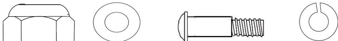
Нейлоновая гайка М8    Плоская шайба М8    Транспортiroвочный болт М8Х25    Пружинная шайба
