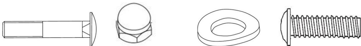
Болт с шестигр. головкой М8Х60    Нейлоновая гайка М8    Изогнутая шайба М8    Болт М8Х20
