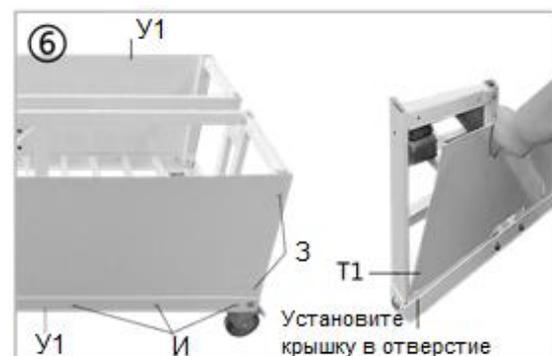
3. Закрепите перекладины (P5) на опоре (P2) баскетбольной стойки и передней опорной балке (P3) при помощи болтов Б, как показано на рисунке 5. Затем закрепите заднюю и боковую крышки (Т1 и У1 соответственно) при помощи винтов (З и И).
