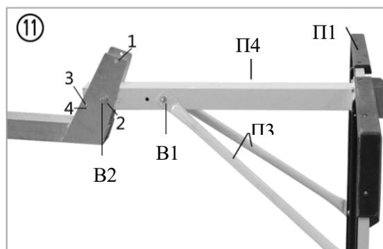
7. Соберите баскетбольный щит, корзину и верхнюю опору в единую конструкцию, как показано на рисунках 10 и 17. Подсоедините опоры для баскетбольного щита (П3) к верхней опоре (П4) и баскетбольному щиту (П1). После этого зафиксируйте верхнюю опору (П4) на регулируемой опоре (H1) при помощи винтов В, как показано на рисунке 11.
