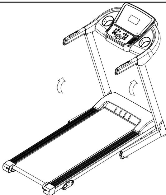
**ШАГ 3** Выдвиньте компьютер и установите его вертикально.
