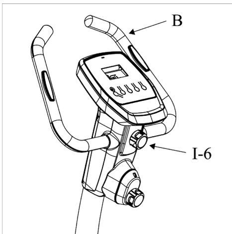
Сидя на тренажере, ослабьте фиксатор (I-6), чтобы разблокировать поручни. Установите поручни (B) в наиболее удобное положение. Затяните фиксатор (I-6), чтобы зафиксировать поручни в выбранном положении.
