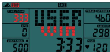
9. Войдите в режим “Manual” — значение пульса должно мигать. Нажмите Вверх ▲ или Вниз ▼, чтобы установить максимальный пульс для тренировки в диапазоне от 30 до 240 с интервалом в 1 удар. Если пульс во время тренировки превысит установленное значение, надпись “Alarm” и “Pulse” начнут мигать. Работает, только если у вас есть нагрудный пульсометр.
