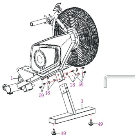
2. Наденьте сиденье (64) на направляющую (2) и закрепите гаечным ключом с крестовой отверткой: 2 прокладки (58), 2 винта с поперечной головкой (56) и 2 плоские шайбы (57). Закрепите задний опорный стабилизатор (4) болтами с шестигранной головкой (59) и тремя плоскими шайбами (18). Затяните универсальным гаечным ключом.
