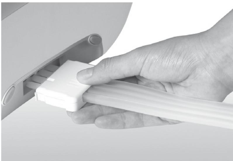
Подключите воздуховод к разъему, как показано на картинке. Проверьте соединение, чтобы избежать утечки воздуха.
