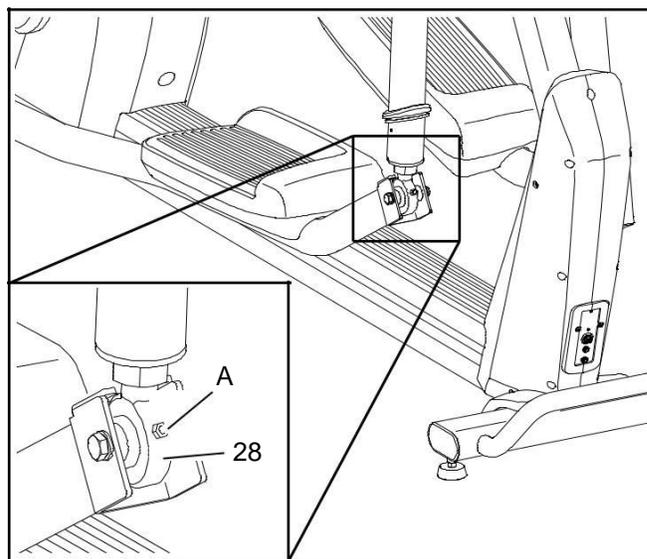
Поле этого уберите смазочный пистолет. **Повторите те же самые действия для смазки второго подшипника (28).** Затем сотрите остатки смазки при помощи тряпки, и заново установите детали тренажёра.
