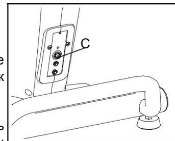
К тренажеру также можно подключить спутниковый приемник, видеомагнитофон или DVD-плеер. Подключите кабель CATV от коаксиального выхода вашего оборудования (обычно обозначенного TV OUT или RF OUT) к разъёму кабеля на передней панели эллиптического тренажера.
