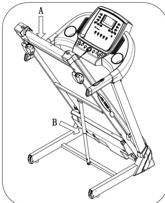
Слегка надавите одной рукой от себя на беговое полотно (A), надавите ногой на цилиндр с пневматической пружиной (B). Беговое полотно самостоятельно примет горизонтальное положение.
