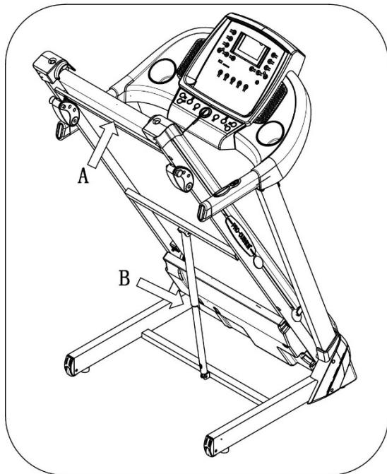
Поднимите беговое полотно в положение (A), пока не сработает фиксатор на цилиндре с пневматической пружиной (B).
