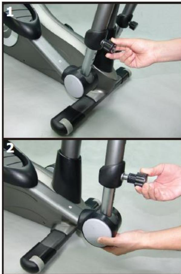
Регулируя высоту подвижного кронштейна, можно менять форму эллипса, чувствительность и интенсивность и, таким образом, настроить свой ЭЛЛИПТИЧЕСКИЙ ТРЕНАЖЁР точно под себя.
